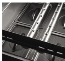
Bras de lavage
